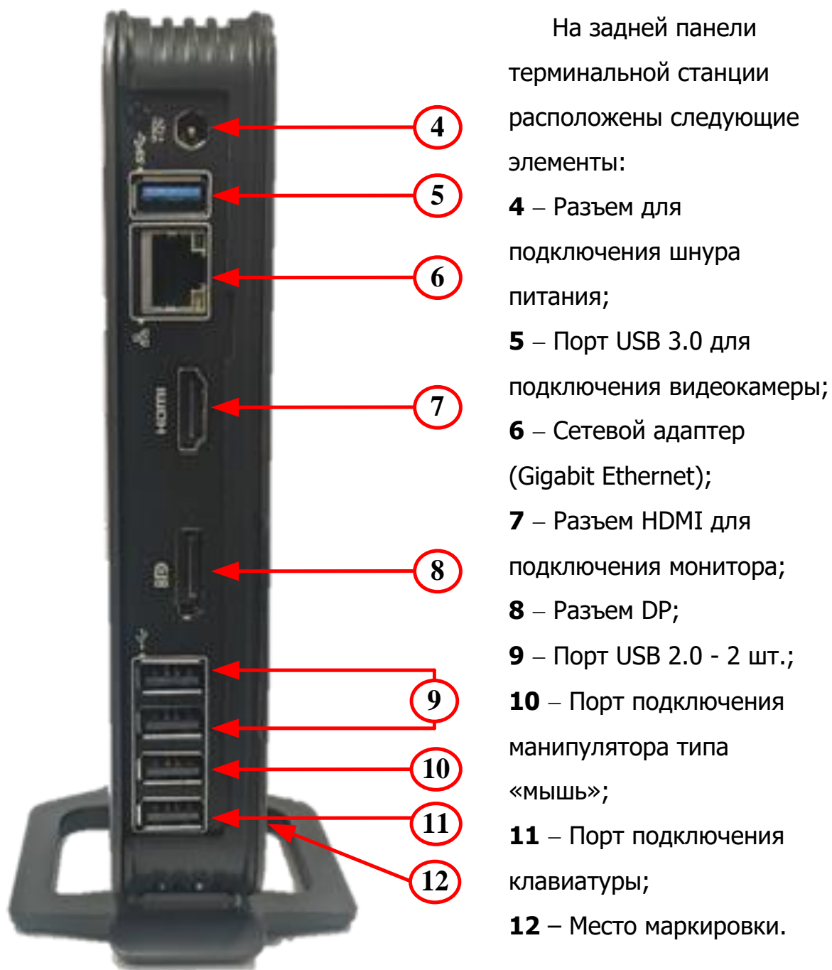
Рисунок 3 – расположение основных элементов на задней панели терминальной станции
